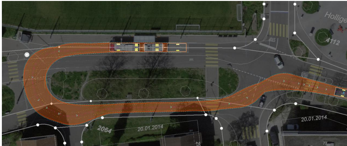
Abbildung 23: Schleppkurvennachweis DTGB-Wende an der Haltestelle Holligen
